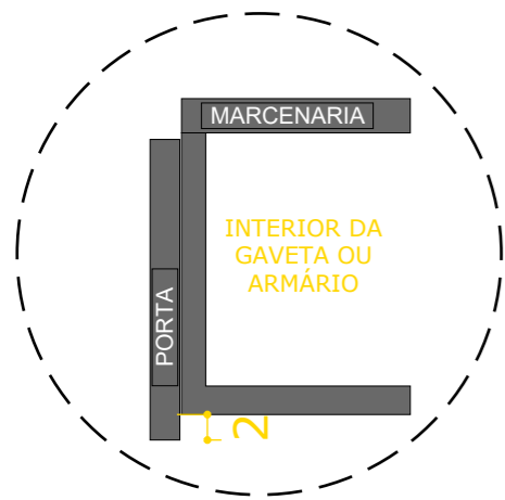
DETALHAMENTO GAVETA / PORTA PASSANTE ESCALA 1:5
