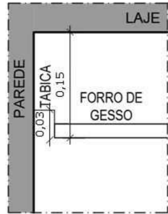
DET. 01 - GERAL TABICA DO GESSO Escala 1:10
